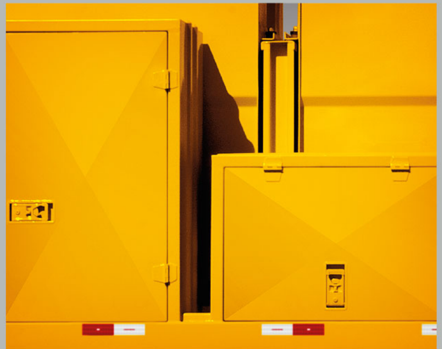
SEPARAÇÃO DE MÓDULOS DIANTEIRO E TRASEIRO (ALÍVIO DE TENSÃO)
