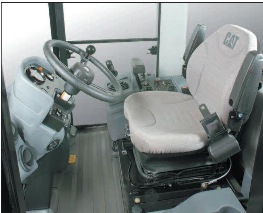
**O console de direção e medidores operacionais** é infinitamente ajustável, dentro da faixa de regulagem, para a posição desejada pelo operador. O console inteiro bascula para facilitar o acesso do operador.
