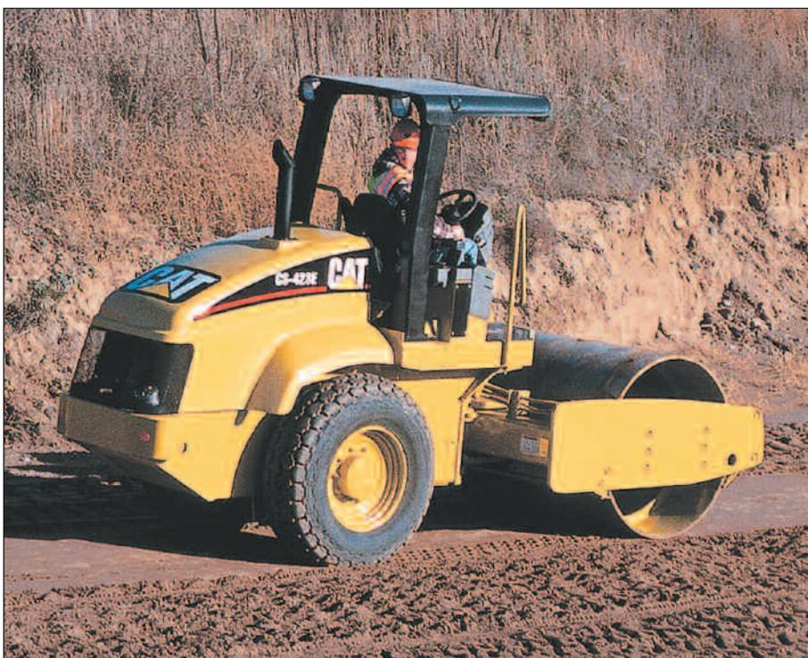
**Visibilidade** para as extremidades dos pneus e traseira da máquina é excepcional. O capô inclinado permite ao operador a visão de obstáculos medindo 1 metro de altura e localizados a 1 metro da traseira da máquina. Excelente visibilidade aumenta a produtividade quando está trabalhando perto de obstruções ou manobrando dentro do canteiro de obras.
