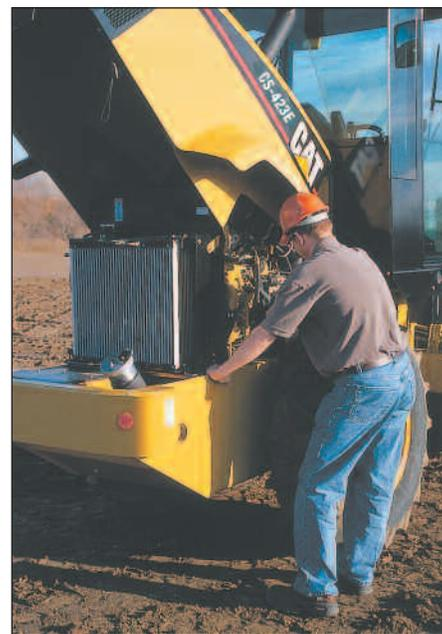
*O capô de peça única inclina para acesso excepcional ao motor e sistema de arrefecimento. Os pontos de manutenção são acessíveis ao nível do solo e agrupados em um lado do motor.*
