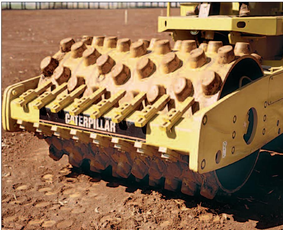
**Raspadores resistentes** montados na frente e atrás do tambor são individualmente ajustáveis e substituíveis. Ajudam a reduzir o excesso de material acumulado entre as patas.
