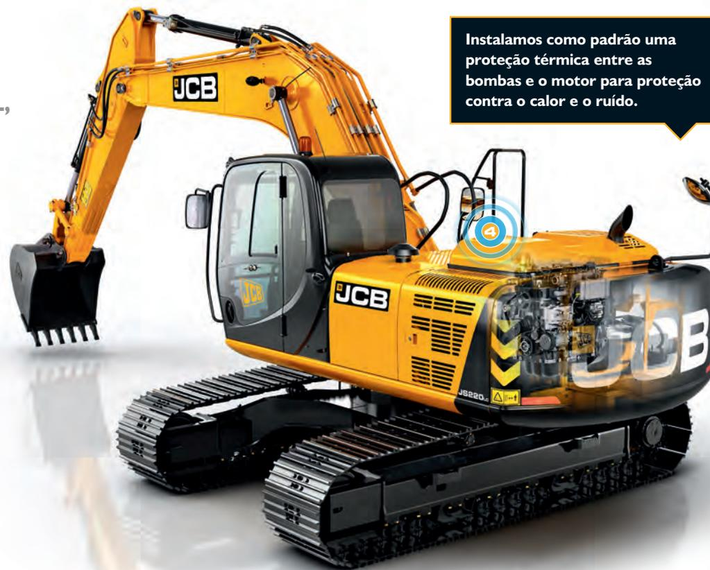
Instalamos como padrão uma proteção térmica entre as bombas e o motor para proteção contra o calor e o ruído.
