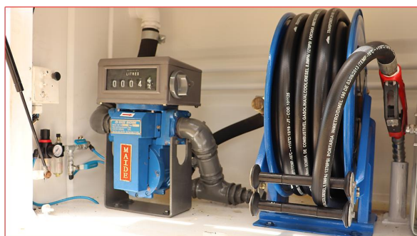
SISTEMA DE ABASTECIMENTO DIESEL 150L/MIN COM MEDIDA VOLUMÉTRICA E CARRETEL
